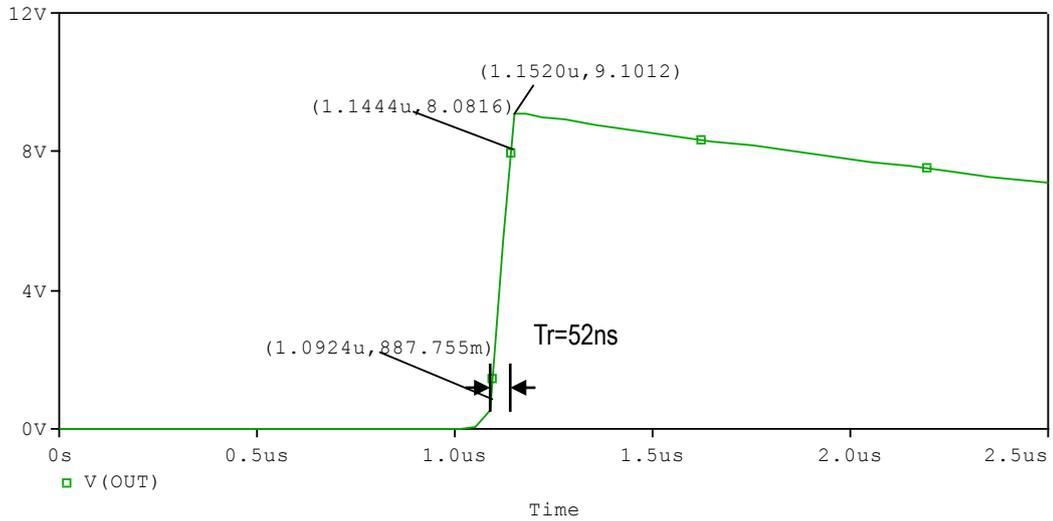
$V_o=9.1012(V)$  at  $V_i=20(V)$ ,  $C_t=0.2\mu(F)$
